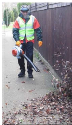
تصویر ۸ - ۱۰) وسایل دمشی و مکشی قابل حمل توسط فرد برای جمع‌آوری برگها در یک محل منبع: www.higiti.ro
