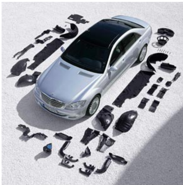
تصویر ۴ - ۴) طراحی اتومبیل با قطعات قابل مونتاژ، قابل استفاده دوباره و قابل بازیافت منبع: www.aftab.ir
