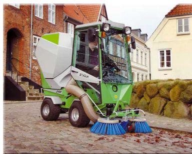
تصویر ۸ - ۱۳) دستگاه‌های جمع‌آوری برگها با مکانیسم غلتکی و جارویی
