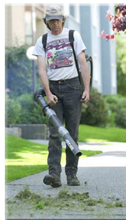
تصویر ۸ - ۱۰) وسایل دمشی و مکشی قابل حمل توسط فرد برای جمع‌آوری برگها در یک محل منبع: www.higiti.ro
