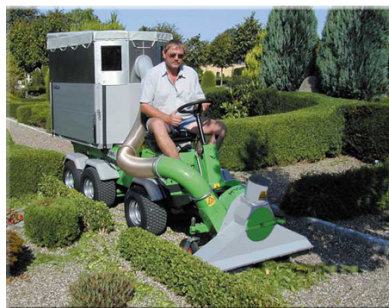
تصویر ۸ - ۱۴) ماشین‌های جمع‌آوری برگها و بقایای گیاهی با مکانیسم‌های جارویی و مکشی
